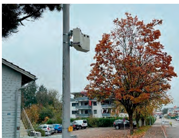
Verkehrszählgerät an der Bachstrasse.
